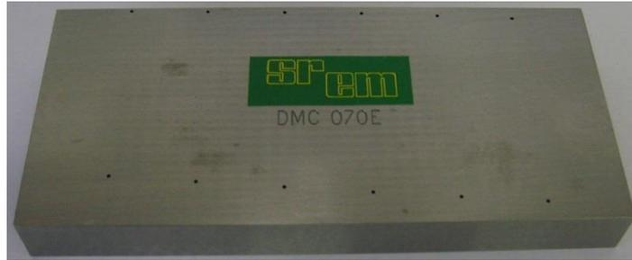
La cale SNECMA est un excellent moyen pour vérifier la polarité des bobines de magnétisation, ainsi que l'efficacité de la magnétisation longitudinale.
